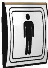
Perfiles de aluminio curvado, en diversos anchos, para la inclusión de placas de señalización. La fijación del perfil puede realizarse mediante tirafondos o usando cinta adhesiva de doble cara. Los laterales se cierran con unas tapas plásticas de color negro que se fijan por tornillos al propio perfil.
